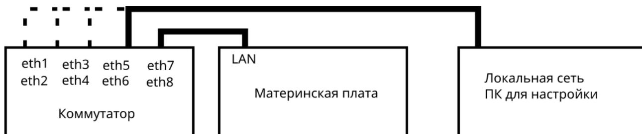
Компьютер видеодетектора имеет ip-адрес 192.168.0.100 и/или 192.168.1.20 на порту LAN.
