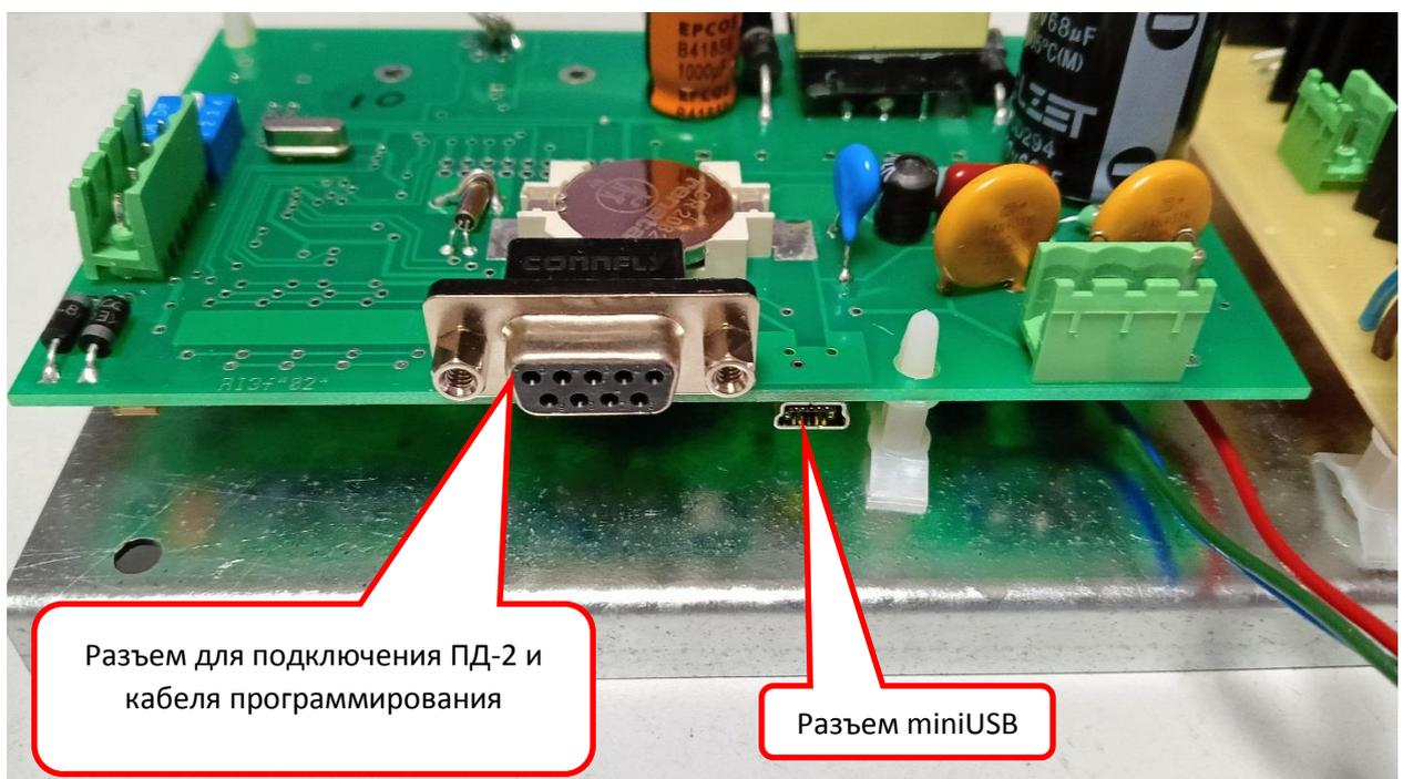
Для конфигурирования интересно использовать разъем miniUSB. Перед программированием надо обесточить устройство отключив разъем питания 220В.
