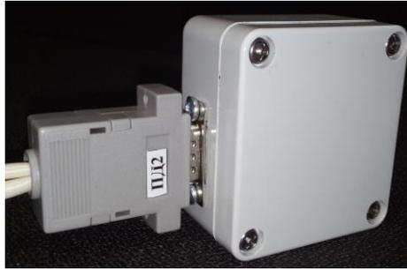
второй конец этого кабеля должен быть подключен к базовому радиомодему. В процессе программирования следует сохранять пространственное положение базового радиомодема как на рисунке, так как в этом случае положения антенн передатчика и приемника максимально совпадают.
