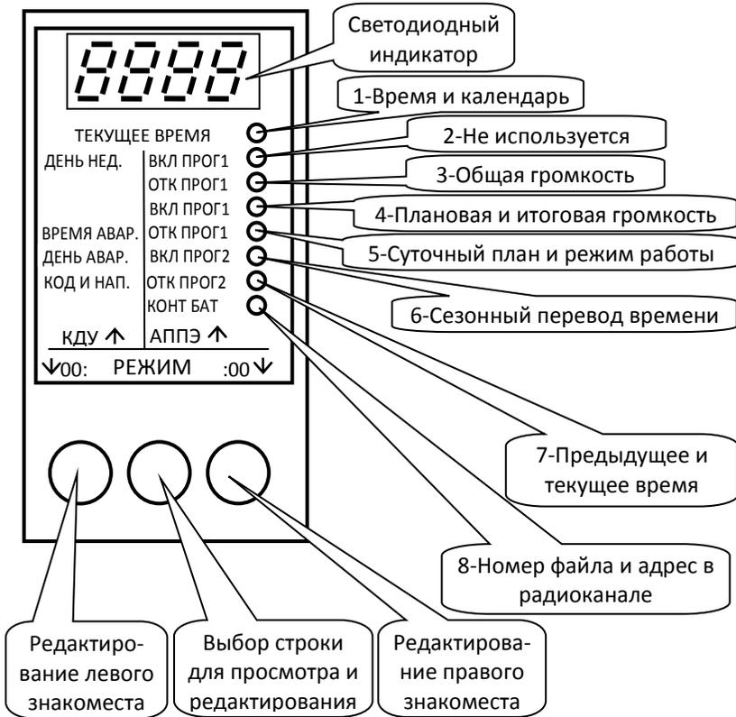
Назначение строк и кнопок пульта ПД-2 при работе с РИ-3.
