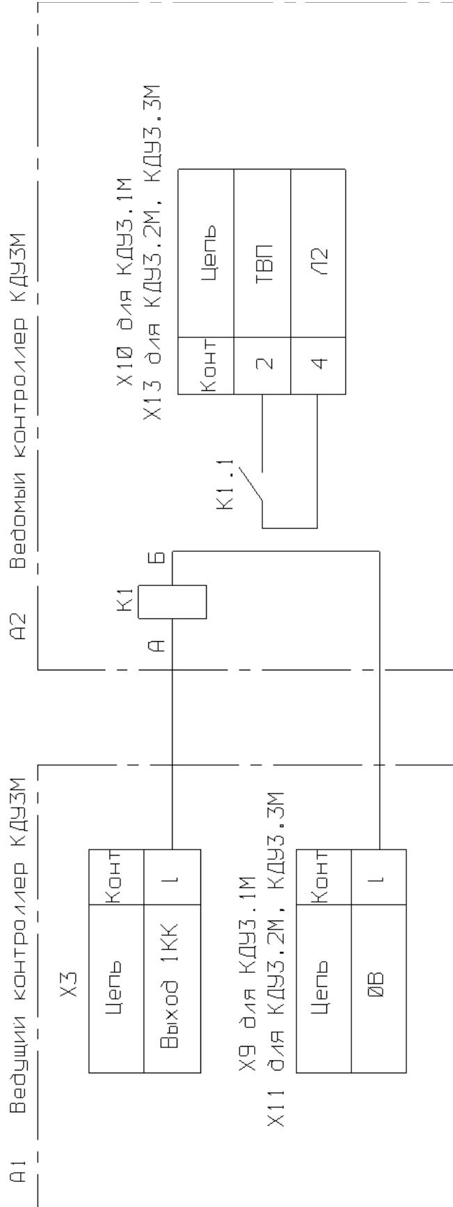
K1 - Реле на рабочее напряжение (напряжение на обмотке) 220В.
