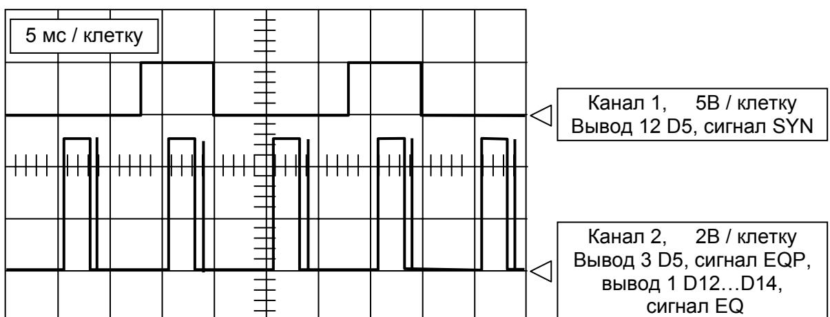
Также, на выводе 28 D5 должны появиться импульсы WDT для схемы регенерации с периодом следования 1 секунда, приводящие к сбросу микроконтроллера импульсами RES. Длительность импульсов WDT и RES может быть иной, но не менее 5 мкс.
